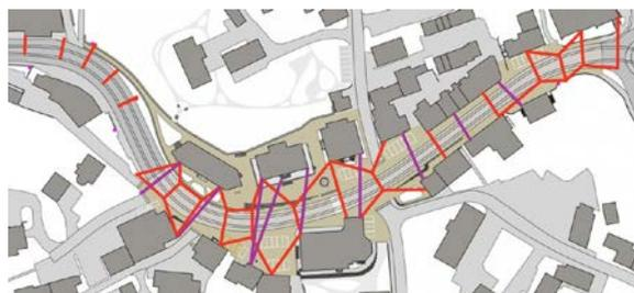
Abb. 4. Gemäss „Zukunft Teufen“ werden sich die Beleuchtung und Fahrleitungsträger wie ein Netz über die Strasse und den Platz im Dorfkern spannen (rot: Fahrleitungsabspannung/-masten, violett: Beleuchtung).
