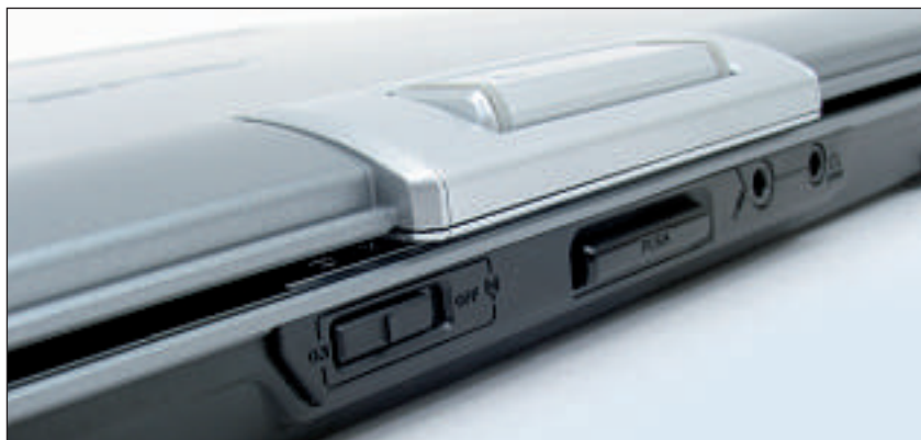
WLAN abschalten: Aktuelle Notebooks besitzen einen Schalter am Gehäuse, mit dem sich der Funkadapter deaktivieren lässt.
