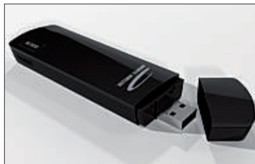
Unterstützt Download-Geschwindigkeiten von bis zu 7.2 Mbit/s: Novatel MC950D USB Connect Stick.
