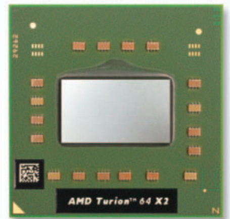
Die: Das silberne glänzende Rechteck in der Mitte ist der Die. Er besteht aus Silizium. Auf dem Die ist der Prozessorkern untergebracht (Bild B)
