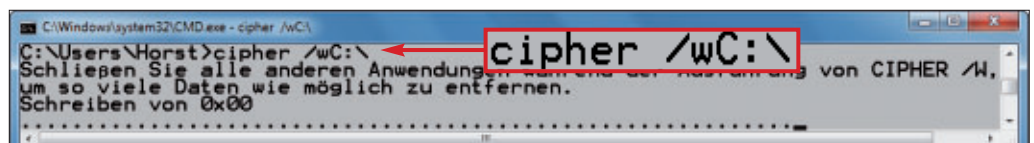
Tipp 31 – Daten sicher löschen: Ein kurzer Kommandozeilenbefehl genügt, um gelöschte Daten sicher zu entfernen, hier auf Laufwerk "C:"
