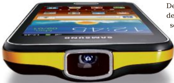
Für Präsentationen: Das Samsung Galaxy Beam ist ein neuer Anlauf für ein Gerät mit Beamer.
