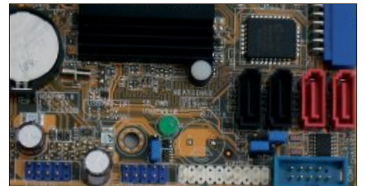
SATA-Anschluss: Eine SSD schliessen Sie wie eine herkömmliche Festplatte per SATA an. Die Anschlüsse sind hier schwarz und rot (Bild D)
