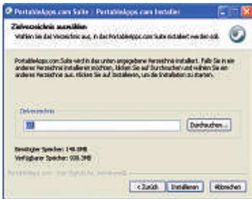
Zielverzeichnis auswählen: Das Setup-Programm kopiert die mitgelieferten Programme auf den USB-Stick (Bild A).
