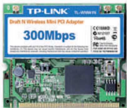
Notebook-Upgrade: Dieser n-Mini-Adapter für 50 Franken ersetzt ein langsames WLAN-Modul.
