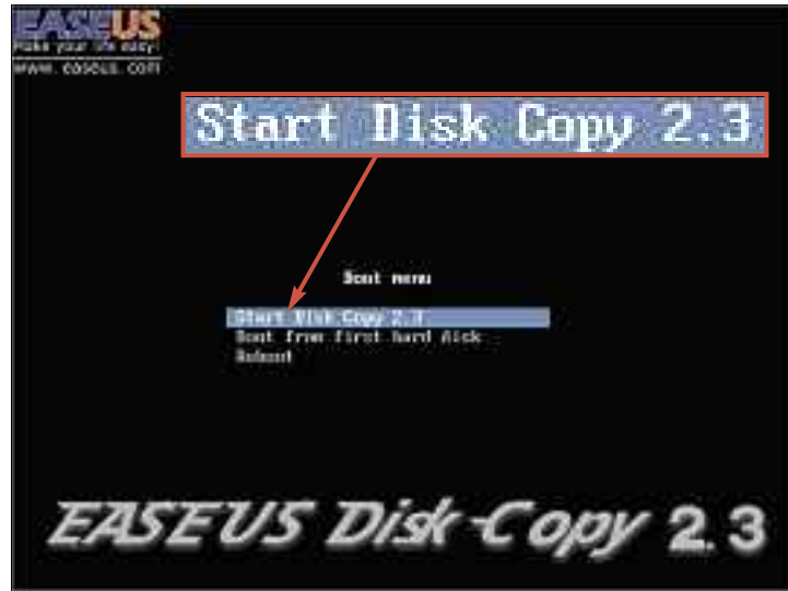
Disk Copy booten: Wählen Sie hier mit den Pfeiltasten den Eintrag "Start Disk Copy 2.3" aus und drücken Sie die Eingabetaste. Daraufhin bootet das Live-System (Bild C)
