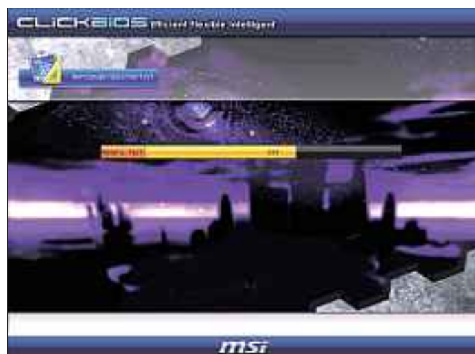
RAM-Test: UEFI lässt sich mit nützlichen Tools ausrüsten. Das UEFI von MSI etwa enthält ein Programm, das den Speicher auf Fehler überprüft (Bild C)
