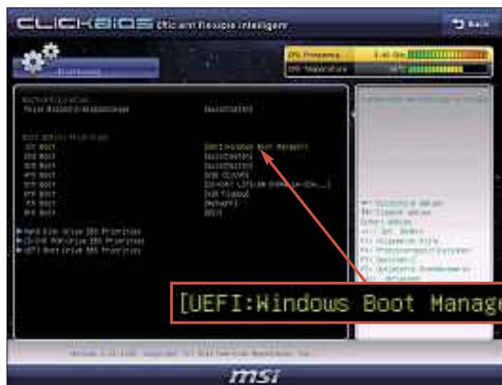
UEFI bootet Windows schneller: Bei PCs mit UEFI wird statt der Festplatte der Bootloader Windows Boot Manager als Startlaufwerk eingetragen. Dadurch startet Windows schneller (Bild D)
