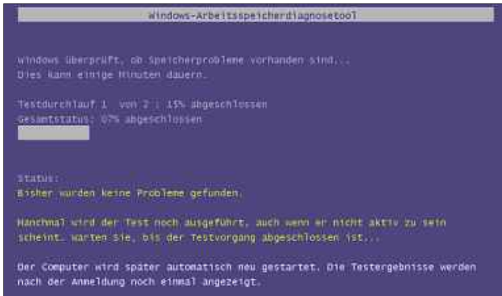
RAM-Check: Das in Windows Vista und 7 enthaltene Analyseprogramm "Windows-Speicherdiagnose" testet den Arbeitsspeicher Ihres Rechners und sucht nach Fehlern (Bild A).
