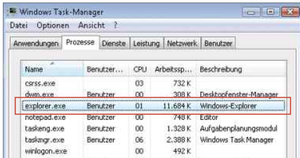
Registry-Eingriff ohne Reboot: Um die Auswirkung eines Registry-Hacks zu sehen, müssen Sie den PC nicht neu starten, nur den Windows-Explorer. Beenden und starten Sie dazu den Prozess "explorer.exe" (Bild B).
