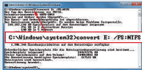
FAT in NTFS umwandeln: Die Konvertierung des Dateisystems starten Sie als Administrator mit dem Befehl convert (Bild A).
