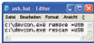
Devcon: Diese Batch-Datei liest die gesamte USB-Konfiguration Ihres Rechners neu ein (Bild D).
